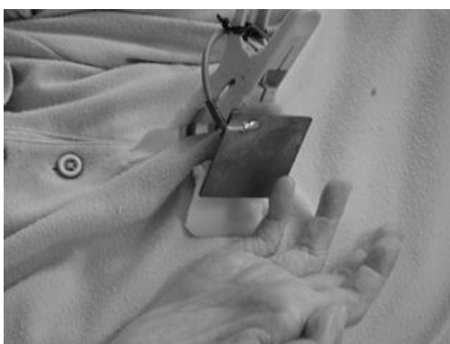
(b) タッチセンサ電極の装着例
