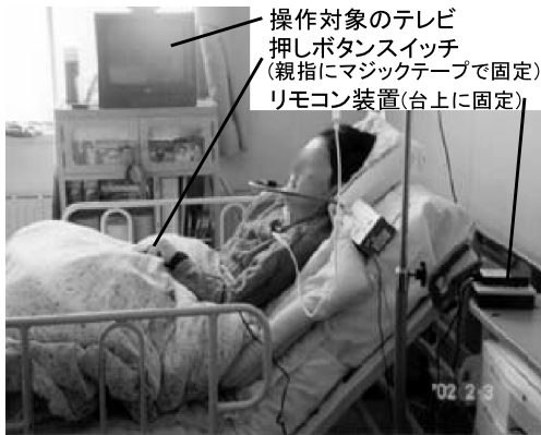
(a) センサ分離型リモコン装置 (図 1(b) に対応)
